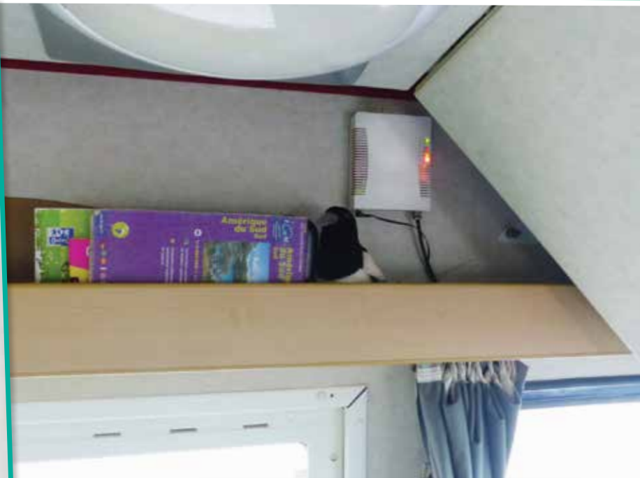
■ Installé à l'intérieur juste derrière l'antenne, le routeur MicroTick .
